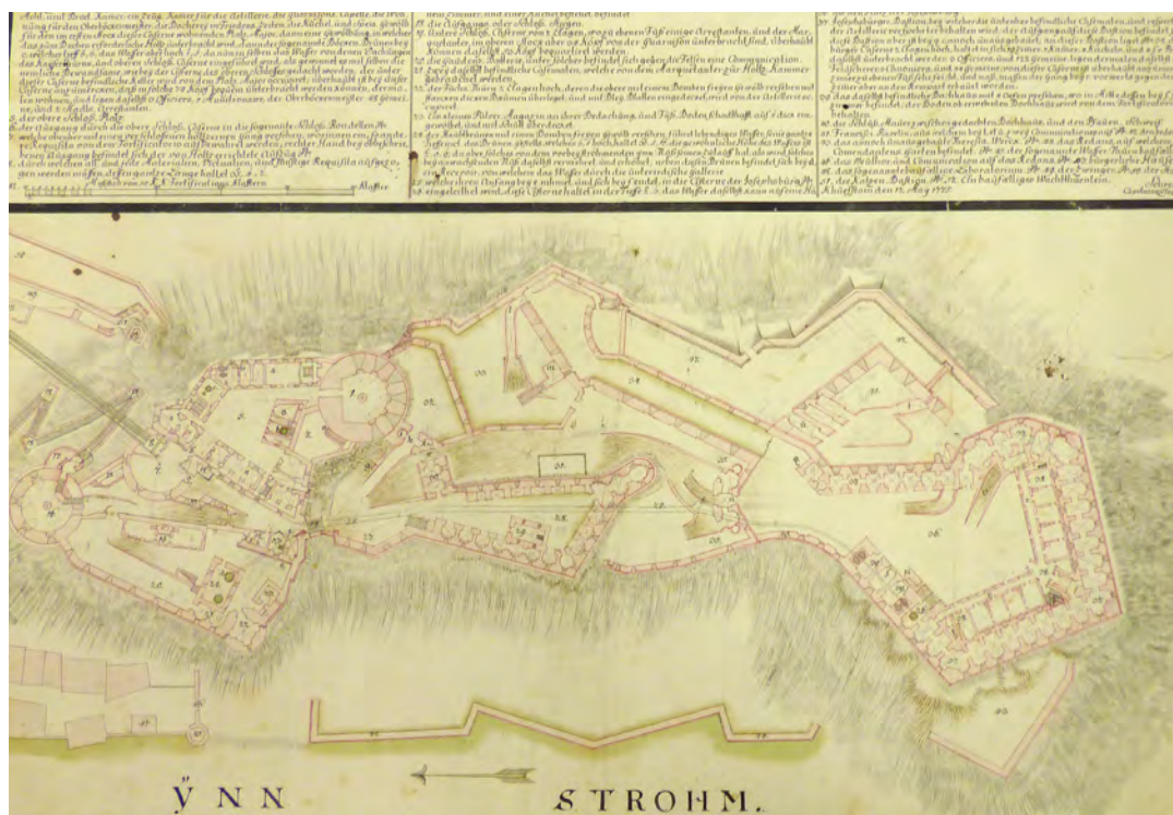
PLAN / Über die Lage, und Grund-Flaeche sammentlicher Wercker, und Gebaeuden der in Tyroll an denen Bayrischen Graentzen, und an den ynnstrohm belegen Berg-Festung Khuefstain, und zeigt nachgesetzte Explication. Federzeichnung, laviert, dat. 17. May 1775, von Schreder. Wien, OESTA KA KPS GPA Inland C II, Kufstein Nr. 17.
