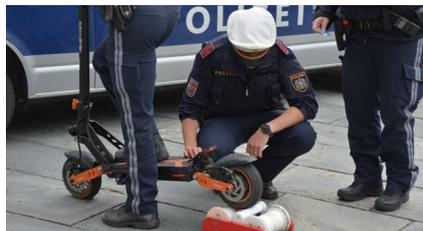
Mithilfe des mobilen Rollenprüfstands wurde die maximale Geschwindigkeit von Mikrofahrzeugen gemessen.
